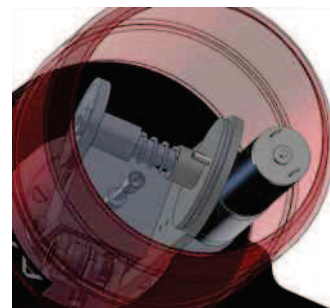
Zespół podajnika obracający się razem z głowicą. Zapobiega to skręcaniu się drutu
